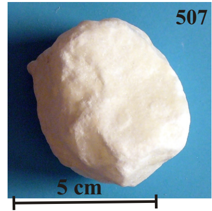
Photo 447 : Gypse saccharoïde, Remarquer les petits cristaux de gypse équi granulaires qui brillent à la lumière. Cet échantillon à structure cristalline très fine est proche de l'albatre.
