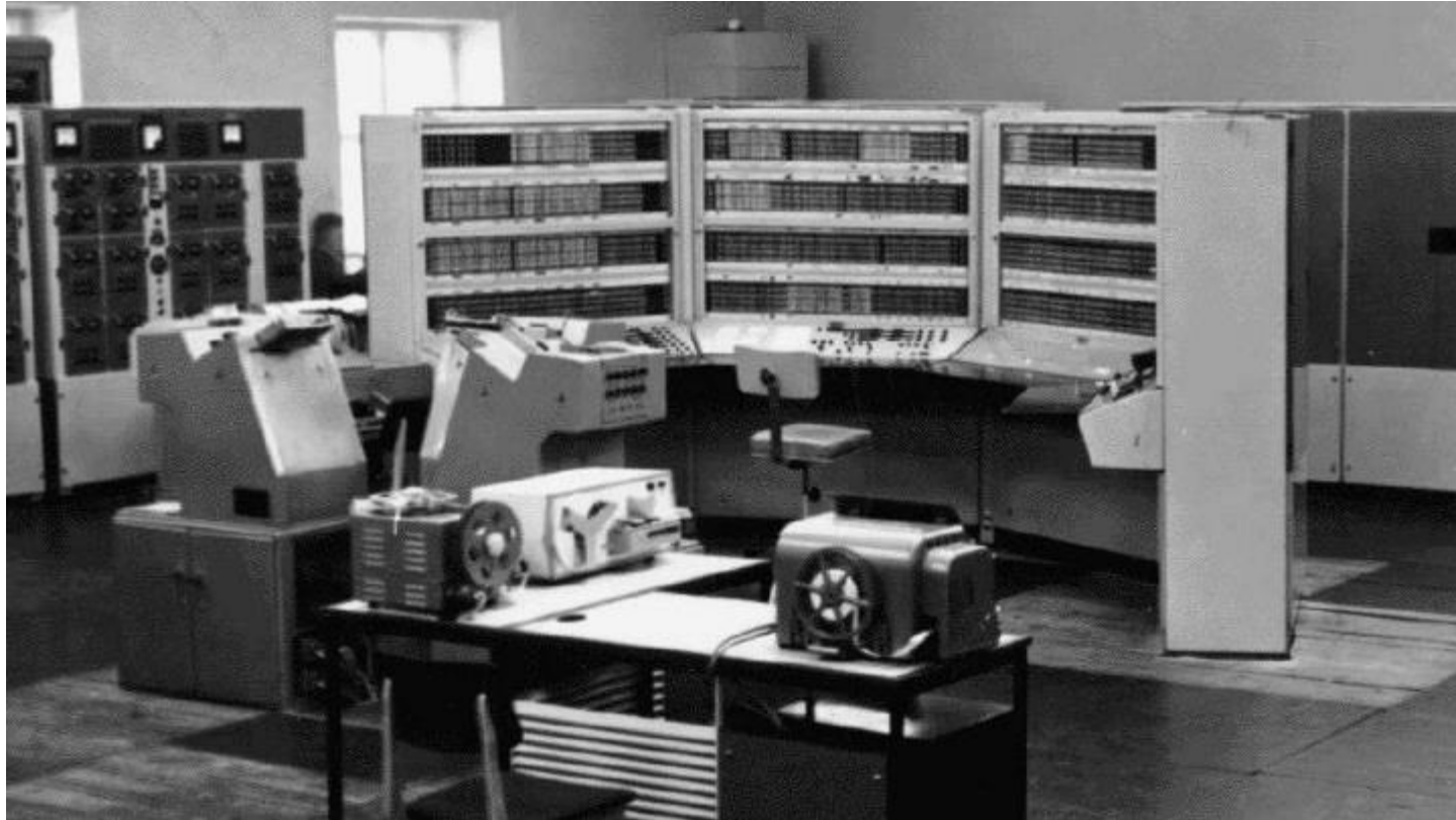
L'ordinateur soviétique BESM-6 , 1965 (48 bits, 9MHz 192ko de mémoire)
