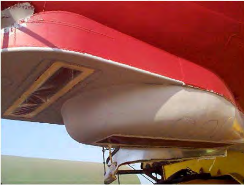
Le Suroît - EM302 - 30 kHz Tx = 3 m / Rx = 1,5 m
