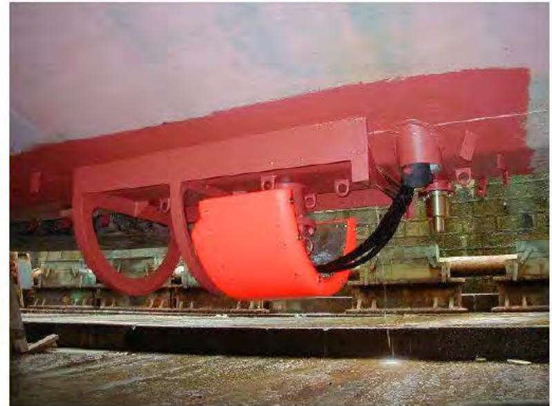
BH2 - EM1002 - 95 kHz Tx/RX : Ø = 0,6 m
