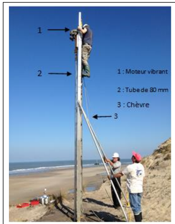
Figure 5. Prélèvement de G1 au niveau de la dune par le carottier Amaury.
